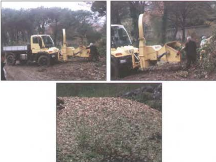
Şekil 54. Budama atıklarını parçalamak için kullanılan yongalama makinesi
